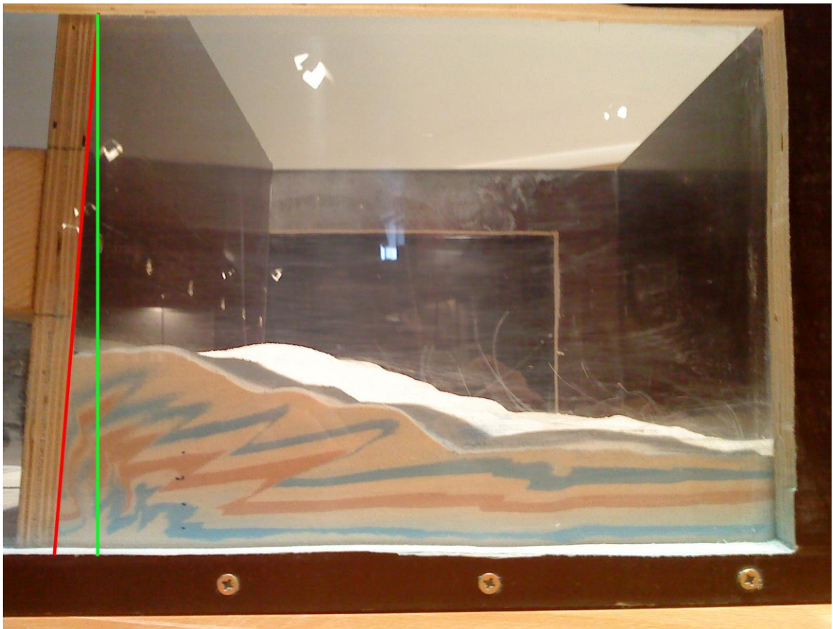
Slika 4: Jedan od pokusa iz 2015. Uočljivo je nagnjanje pomičnog zida kao nedostatak izvornog dizajna aparature.
