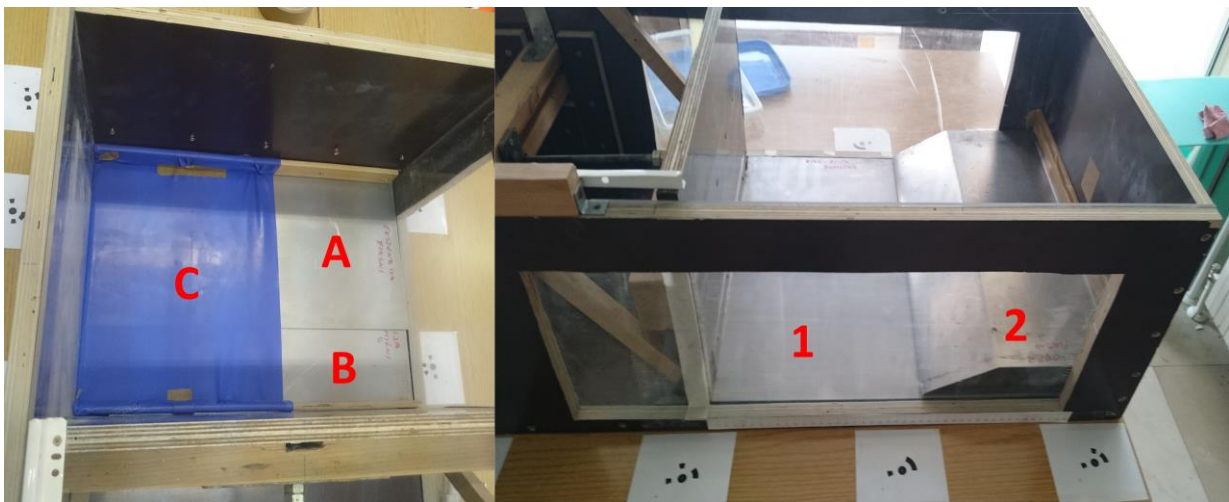
Slika 6: Izrađeni setovi limova i izgled aparature pred postavljanje pokusa ekstenzije (lijevo) i pokusa kompresije na rasjednoj rampi (desno). Desno: (1) lim pričvršćen na pomični zid, (2) lim pričvršćen na fiksni zid. Lijevo: (A) lim pričvršćen na fiksni zid, (B) lim pričvršćen na pomični zid, (C) guma.
