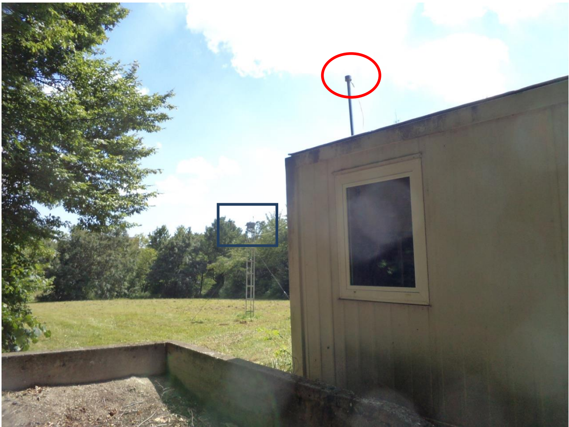
Slika 1. Lokacija mjerenja lebdećih čestica i ozona na travnjaku Instituta Ruđer Bošković (IRB). Ulaz zraka u instrument za mjerenje volumnih koncentracija ozona (Environnement S.A., tip O3 41M, broj 1476, Francuska) naznačen je crvenom elipsom, a položaj instrumenta za mjerenje masenih koncentracija lebdećih čestica (laserski fotometar DUSTTRAK™ AEROSOL MONITOR MODEL 8533, TSI, SAD) plavim pravokutnikom.
