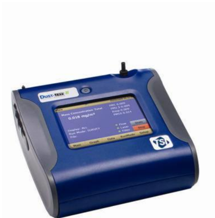
Slika 2. DustTrak Aerosol Monitor Model 8533 (TSI, SAD) korišten u ovoj studiji za mjerenje masenih koncentracija lebdećih čestica PM_1 , PM_{2.5} i PM_{10} .
