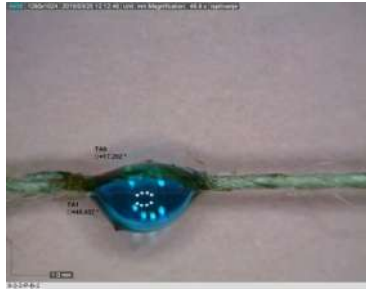
Slika 48. Kut prelijevanja/donji kut kapi smole
