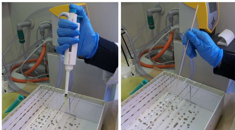
Slika 44. Nanošenje smole : a) nanošenje smole mikropipetom, b) nanošenje smole drvenim štapićem s šiljastim vrhom
