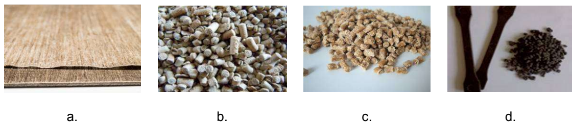
Slika 11. Netkano istosmjerno ojačano predimpregnirano ojačalo: a) PROCOTEX, UD laneni prepreg, matrica: TP i TS; Polimerni granulati ojačani kratkim vlaknima: b) LINCORE CP ©, Groupe Depestele, lan, matrica: PVC (polivinilklorid), PP (polipropilen), PLA (poliaktidna kiselina), ABS (acrylonitril butadien stiren); c) AFT PLASTURGIE, konoplja, matrica: ABS (acrylonitril butadien stiren), PVC (polivinil-klorid), PE (polietilen), PP (polipropilen); d) ECOTECHNILIN, lan, matrica: PPC (polipropilen karbonat) [13]
