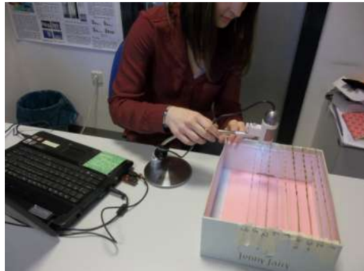
Slika 47. Fotografiranje prijenosnim USB optičkim mikroskopom – Dino-Lite
