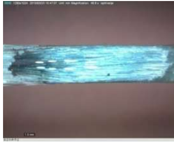
Slika 50. Adhezija smole 2 na površini visokoorijentirane pređe iz staklenih vlakana - tlocrt
