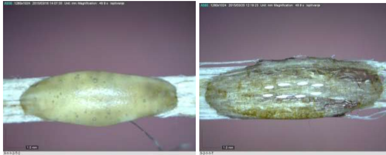
Slika 37. Promjena tona smole dodatkom katalizatora : a) smola 1, b) smola 2
