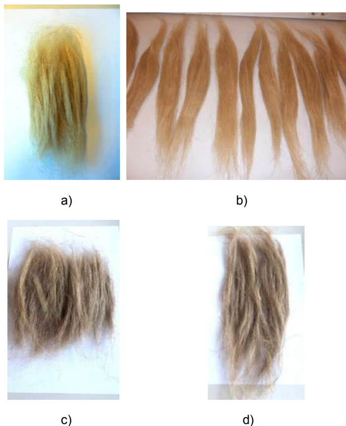
Slika 28. Snopići vlakana lana : a) predivi lan – kraća vlakna, b) predivi lan – dulja vlakna, c) sjemenski lan – kraća vlakna, d) sjemenski lan – dulja vlakna
