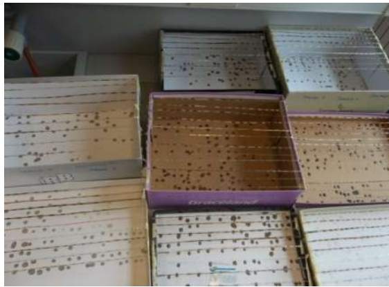
Slika 45. Uzorci pređa učvršćeni na kartonske nosače s skrutnutim kapljicama smole
