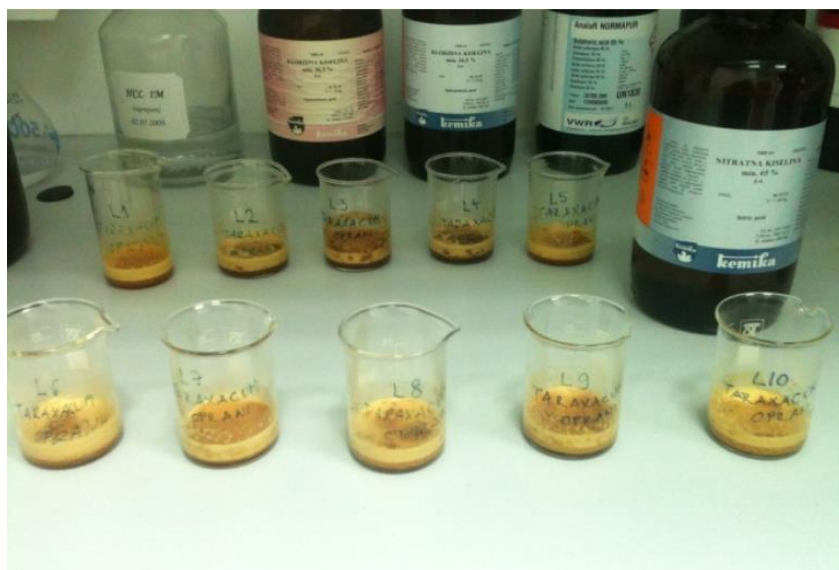
Slika 22. Pripremljeni biljni uzorci s dodanom nitratnom i perkloratnom kiselinom za određivanje prisutnosti teških metala.
