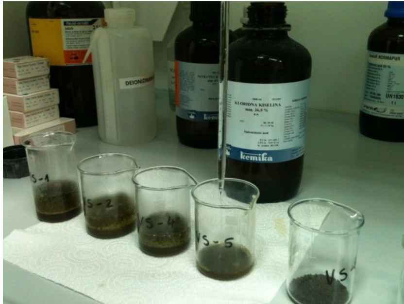
Slika 19. Pripremljeni uzorci tla s dodanom zlatotopkom za određivanje prisutnosti teških metala.
