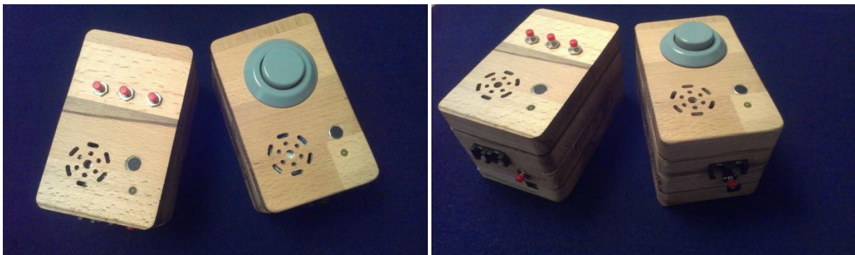
Slika 30. i Slika 31. Napravljena dva modela govornog telefonskog imenika, s tri gumba i s rotacijskim gumbom.
