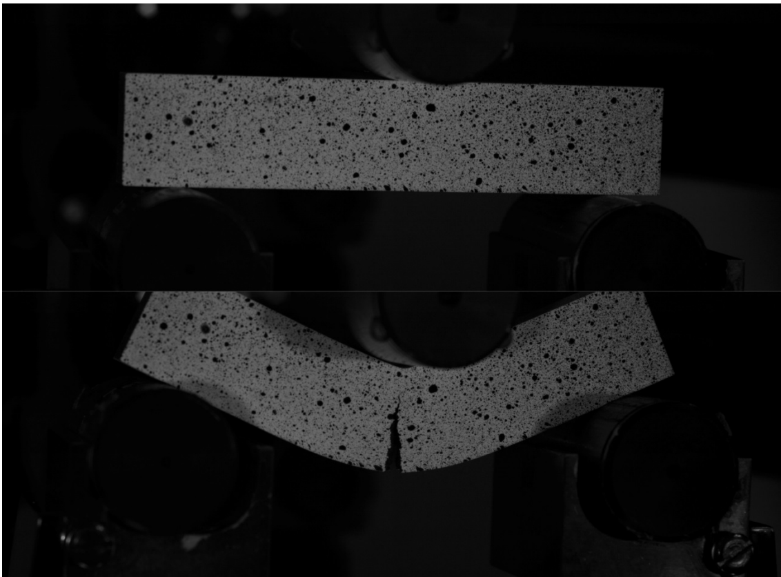
Slika 16. Epruveta E1 prije i nakon ispitivanja savijanjem u tri točke brzinom od 20 mm/s
