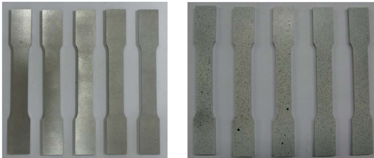
Slika 10. Plosnate epruvete za vlačno ispitivanje u početnom stanju (lijevo) te nakon nanošenja spreja sa stohastičkim uzorkom (desno)
