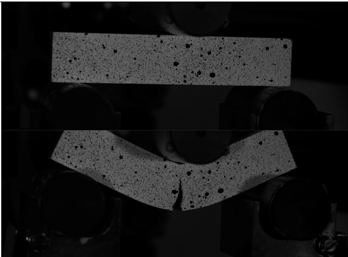
Slika 17. Epruveta E2 prije i nakon ispitivanja savijanjem u tri točke brzinom od 20 mm/s
