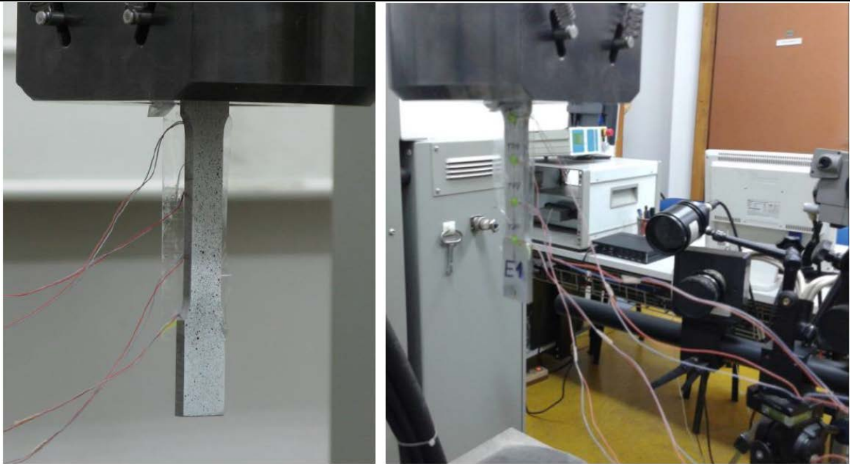
Slika 11. Postupak postavljanja epruvete u čeljust kidalice
