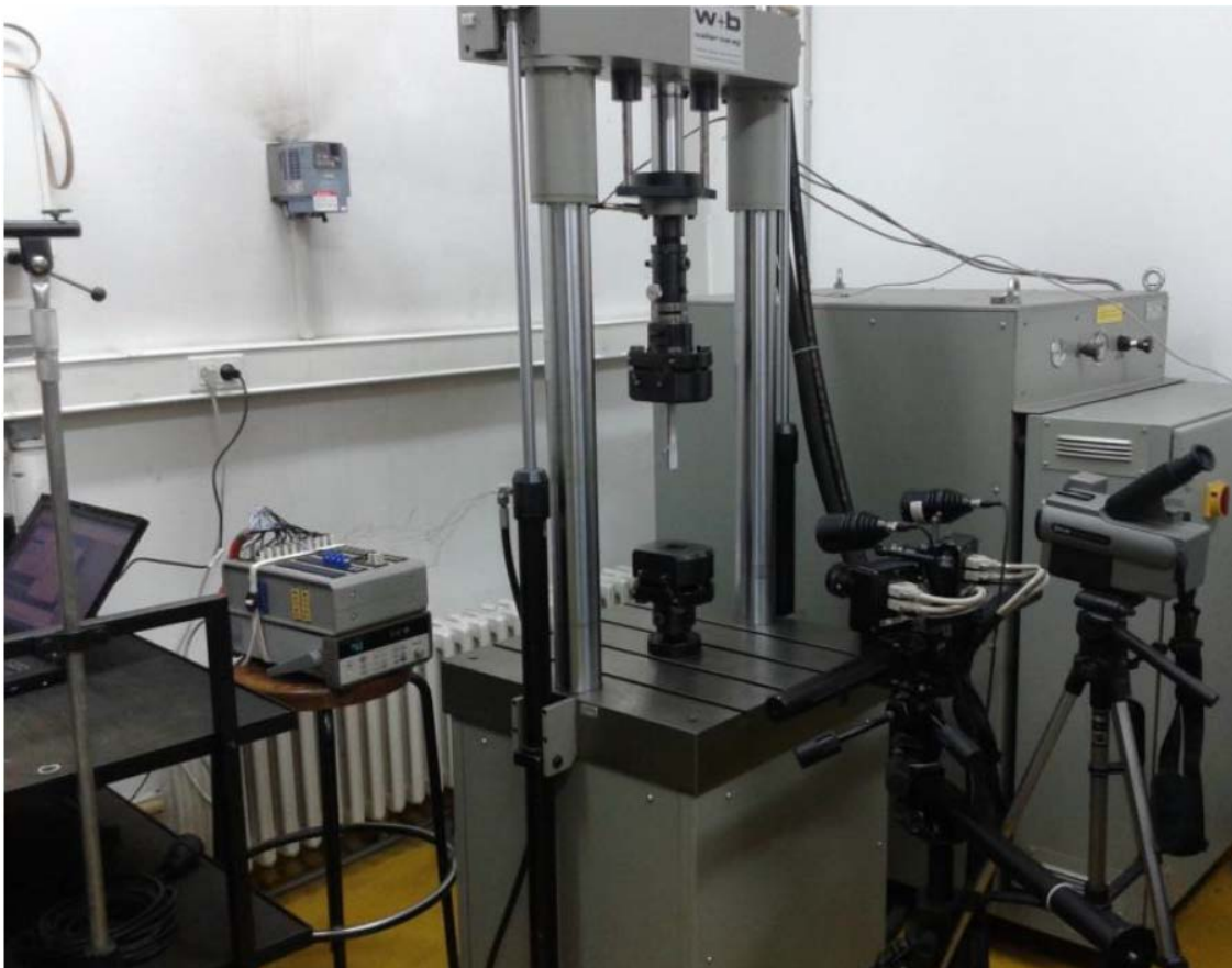
Slika 11. Postupak postavljanja epruvete u čeljust kidalice
