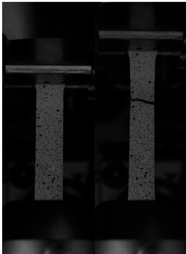
Slika 14. Epruveta E1 prije i nakon deformiranja do loma brzinom od 20 mm/s
