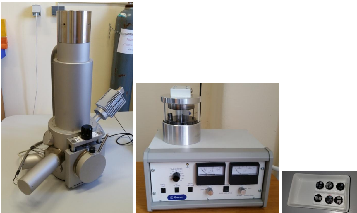
Slika 21. Pretražni elektronski mikroskop Tescan Vega serija 3, Bruker, uređaj za neparivanje vodljivog sloja zlata i napareni uzorci
