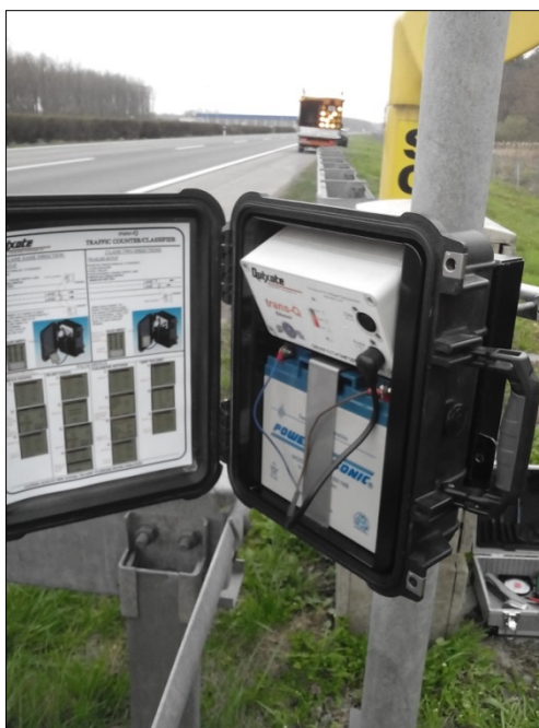
Slika 11. Mjerni uređaj Trans-Q Radar Traffic Classifier na autocesti A1
