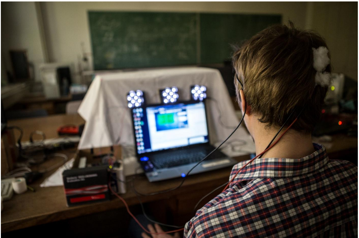
Slika 33: Eksperiment – ispitanik s postavljenim elektrodama gleda u treptave šahovnice
