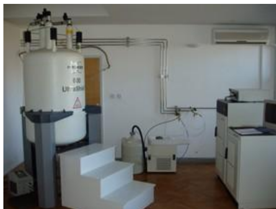
Slika 3.12. NMR instrument Bruker Avance 600 MHz 21
