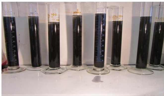
Slika 3.19. Sedimentacijski testovi priređenih nanofluida
