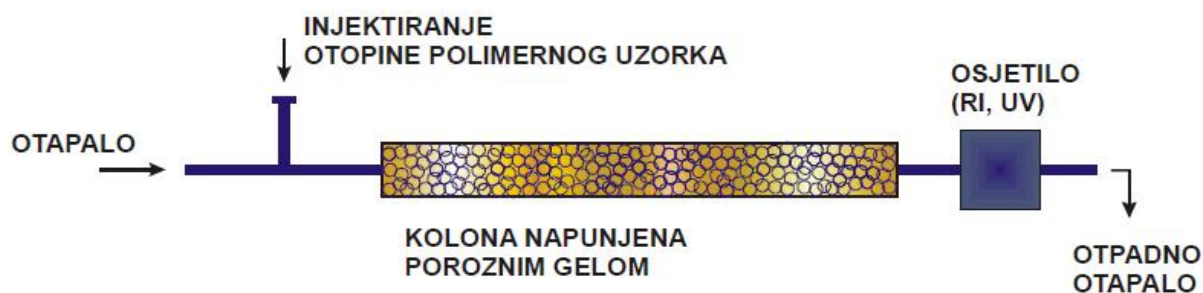
Slika 3.13. Skica SEC/GPC uređaja 20
