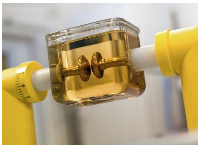
Slika 3.20. Ispitna ćelija uređaja za određivanje probojnog napona 27
