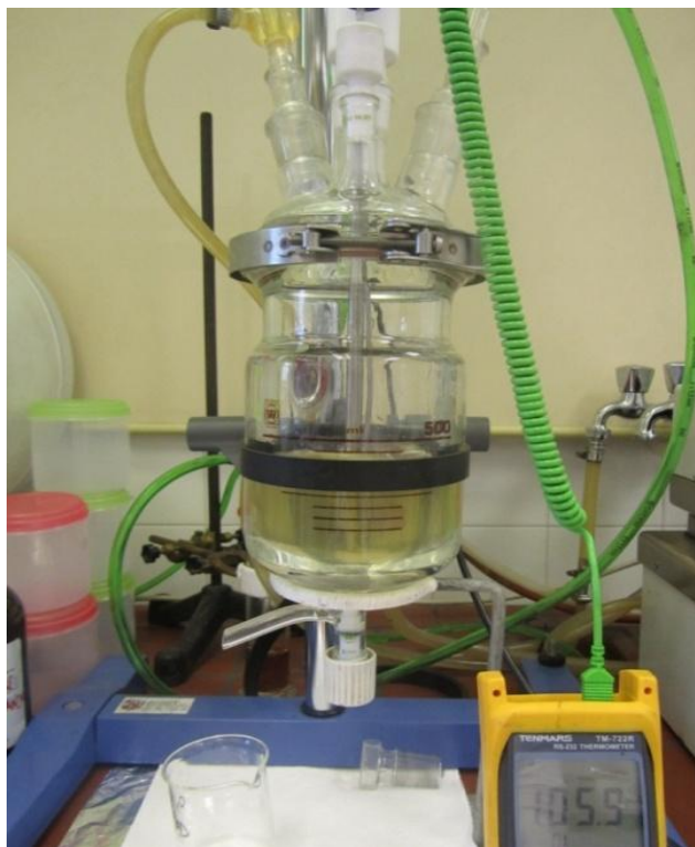
Slika 3.7. Reaktorski sustav za sintezu kopolimernih površinski aktivnih tvari
