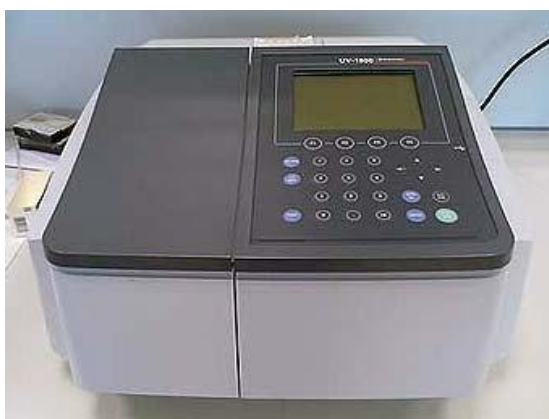
Slika 3.18. UV-Vis spektrofotometar Shimadzu UV-1800 24
