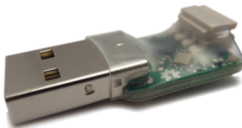
Slika 16: USB2AX posrednik u komunikaciji [30]
