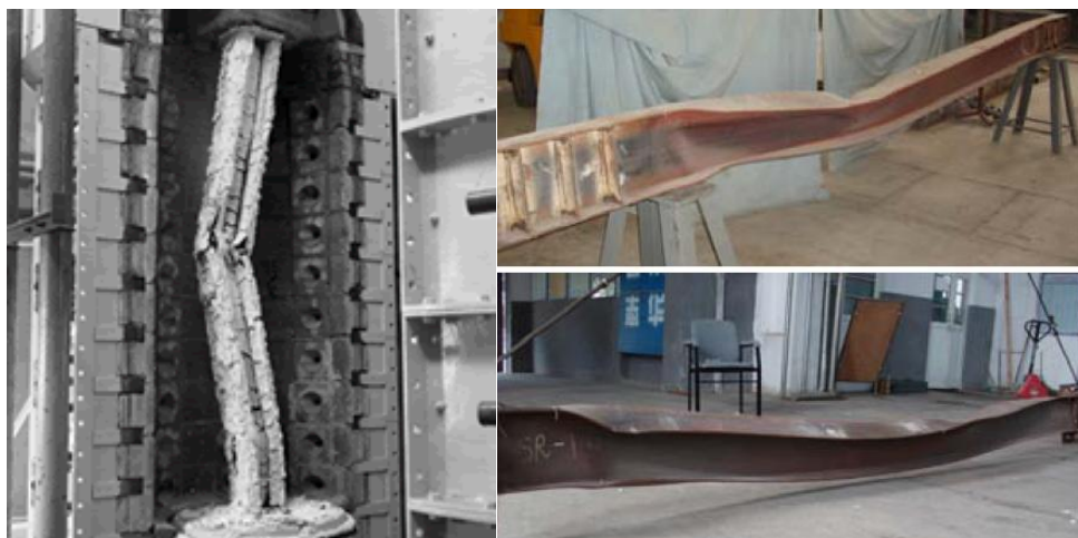
Slika 3.2. Požarno ispitivanje čeličnih elemenata: stup (lijevo), [13], i greda (desno), [14]
