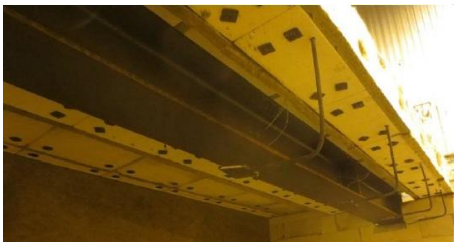
Slika 4.11. Čelični nosač postavljen u peć za ispitivanje
