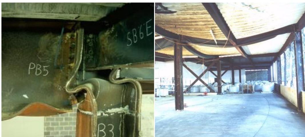
Slika 3.1. Cardington požarno ispitivanje na kompletnoj konstrukciji, [11]
