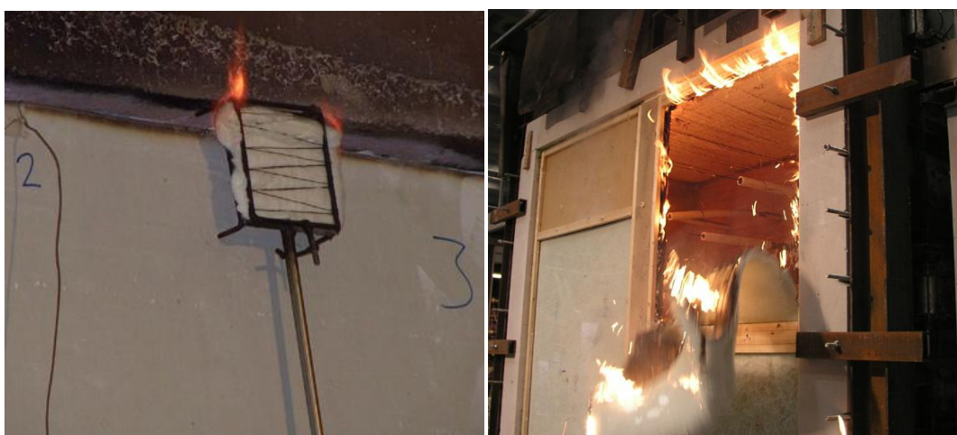
Slika 3.3. Otkazivanje uvjeta cjelovitosti – zapaljenje pamučnog jastučića (lijevo) i nastajanje otvora (desno), [16]
