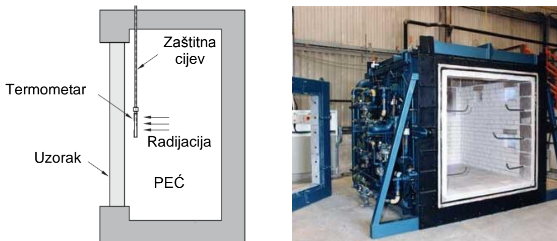
Slika 3.4. Peć za ispitivanje čeličnih elemenata na požar
