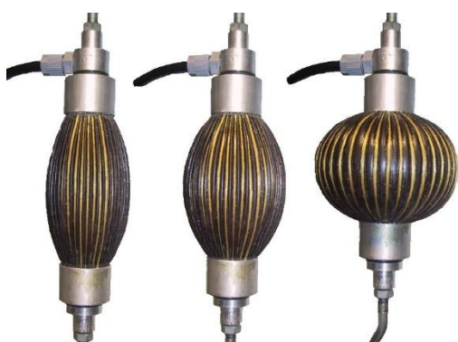
Slika 19: Pneumatski mišić s uzdužnom armaturom [11]
