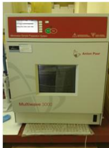
Slika 34. Zatvoreni mikrovalni sustav (Anton Paar - Multiwave 3000) za raščinjavanje uzoraka djelovanjem mikrovalova.
