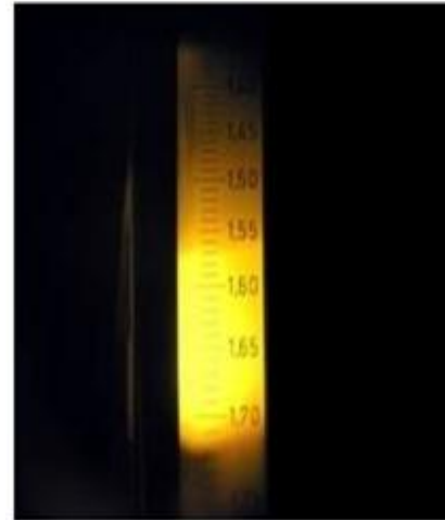
Slika 28. Svijetlo i tamnije područje na mjernoj traci vidljivo kroz okular refraktometra, granica predstavlja indeks loma ispitivanog materijala (izvor: http://www.bwsmigel.info/lesson4/de.optical.properties.html ).
