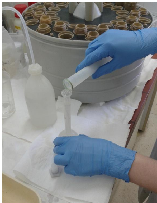
Slika 35. Priprema uzoraka za mjerenje na ICP-MS uređaju; prebacivanje uzorka u tikvicu i razrjeđivanje s Mili-Q vodom.
