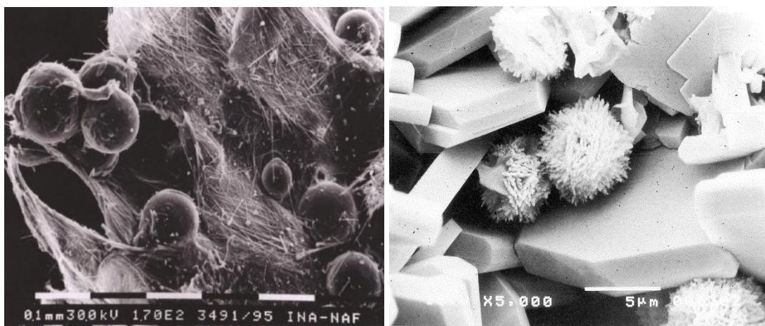
Slika 48. Fotografije snimljene skenirajućim elektronskim mikroskopom (SEM). Na slici lijevo uočavaju se sitna vlakanca mordenita sa sferulama opala-CT iz žile alterirane piroklastične stijene iz Lepoglave; na slici desno dan je primjer pločastog klinoptilolita također sa sferulama opala-CT (preuzeto iz: Šoufek i dr., 1995; Morbidelli i dr., 1999).
