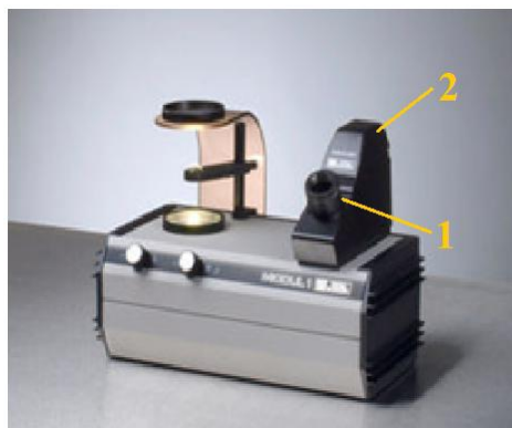
Slika 29. Refraktometar, 1-okular, 2-nosač uzorka kojem se određuje indeks loma (izvor: http://www.eickhorst.com/en/gemmological-instruments ).
