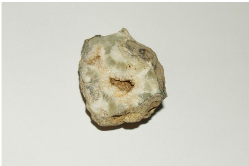
Slika 17. Izgled jedne šupljine iz eruptivne stijene u kojoj je iskristalizirao radijalnozrakasti agregat prehnita veličine oko 2 cm. Na slici se vide bijeli prehniti prvotno iskristalizirani koji kasnije postaju mutno zelenkasti do žutozelenkasti.
