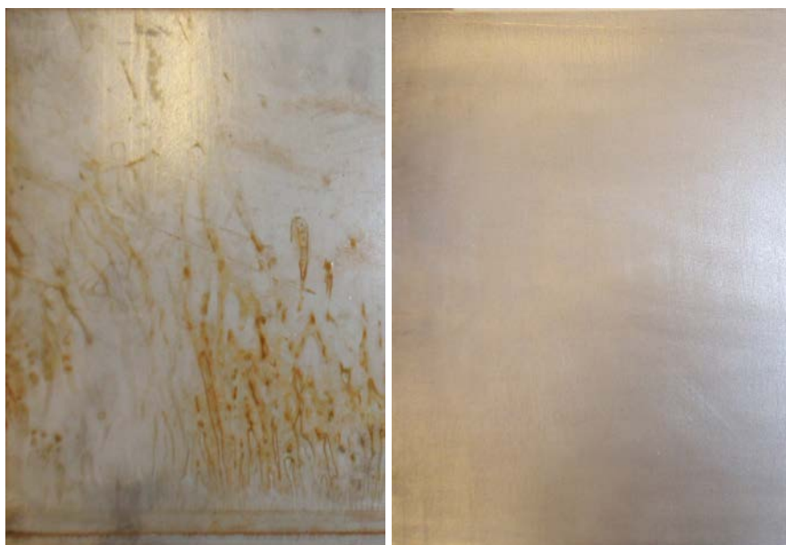
Slika 3.3 Prikaz površinske pripreme osnovnog materijala, lijevo-neočišćeno, desno-očišćeno
