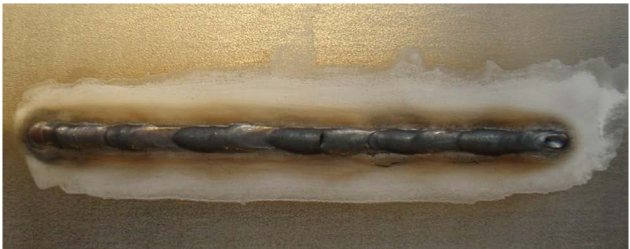
Slika 4.1 Lice navara izvedenog u zaštitnoj atmosferi mješavine 95 % Ar / 5 % H (aktivacijski premaz s 100 % SiO 2 )
