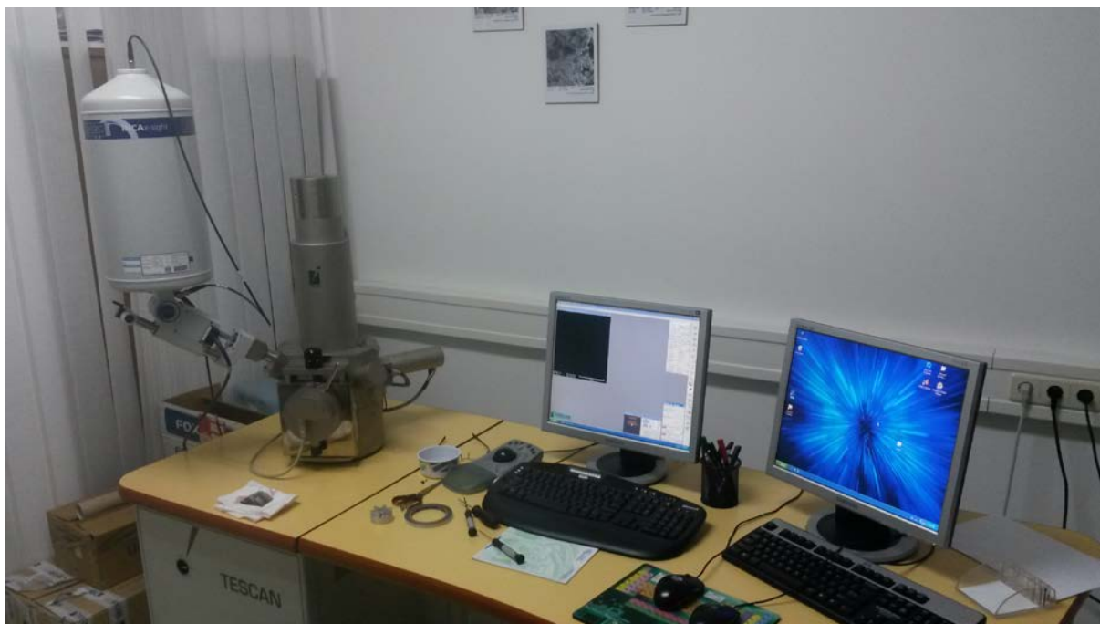
Slika 3.10 Tescan Vega TS5136 – pretražni elektronski mikroskop (SEM)
