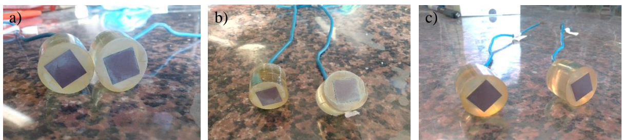
Slika 9. Sulfatna patina zaštićena stearinskom kiselinom: (a) uranjanjem; (b) kistom; (c) netretirana sulfatna patina
