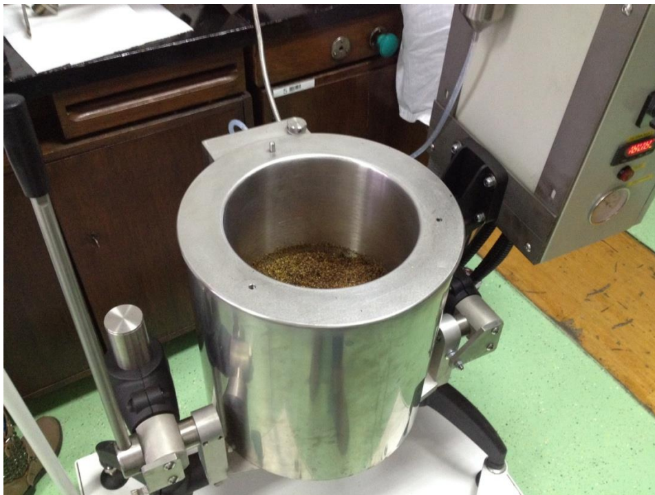
Slika 5. Posebno izrađen kondicioner u kojem se provodilo kondicioniranje sjemena uljane repice (vlastita fotografija)
