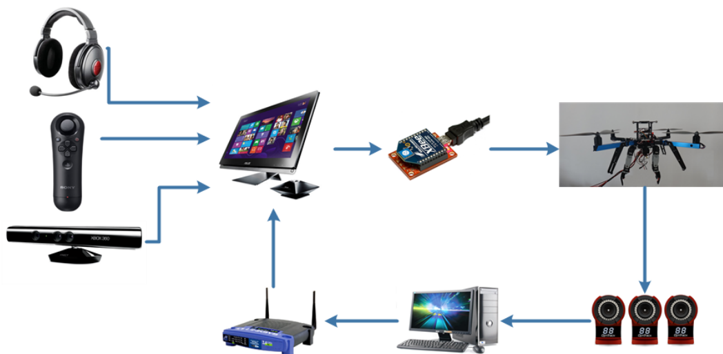
Slika 35: Pojednostavljena shema upravljanja putem proširenog korisničkog sučelja
