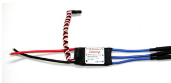
Slika 7: ESC sklop za generiranje trofaznog izmjeničnog napona
