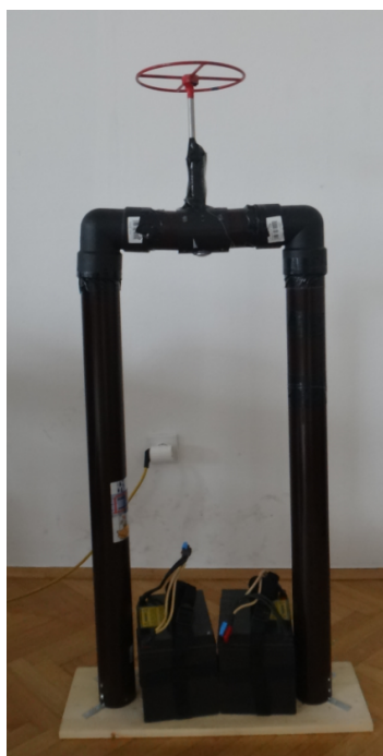
Slika 20: Metalni ventil montiran na plastične cijevi
