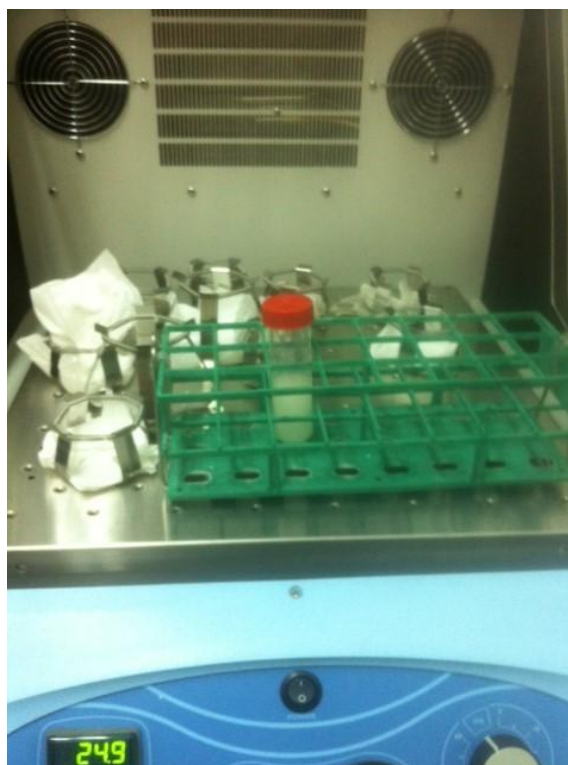
Slika 5. Završna faza sinteze zrnaca, inkubacija 40 sati na 20°C uz potresanje na 250rpm
