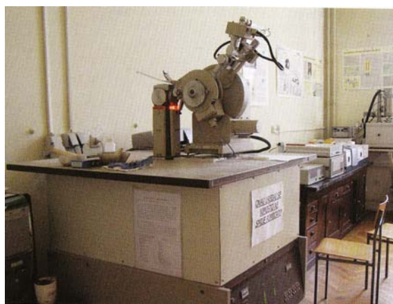
Slika 12 Rendgenski difraktometar, Philips PW 1830 (Zavod za anorgansku kemijsku tehnologiju i nemetale, FKIT)
