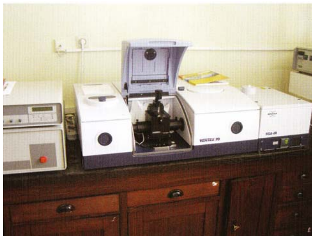
Slika 13. Infracrveni spektrofotometar s Fourierovom transformacijom, Bruker Vertex 70 (Zavod za anorgansku kemijsku tehnologiju i nemetale, FKIT)
