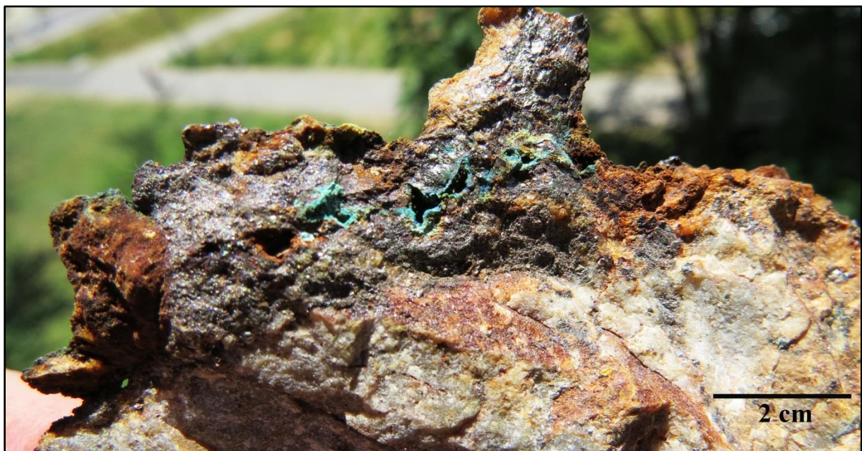
Slika 24. Malahit i azurit ispunjavaju šupljine izluženog halkopirita uz uvjete povišenog pH, zbog puferskog djelovanja dolomitne stijene domaćina.
