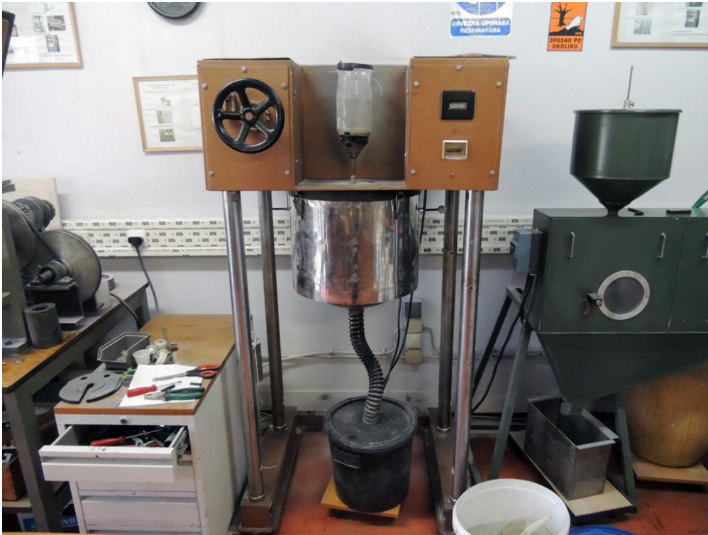
Slika 3.11 Uređaj za ispitivanje otpornosti na erozijsko trošenje
