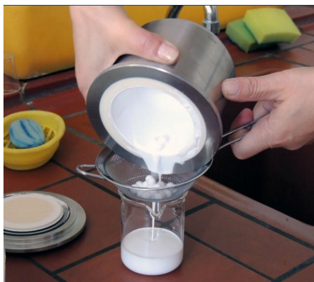
Slika 3.4 Odjeljivanje keramičkih kuglica od suspenzije
