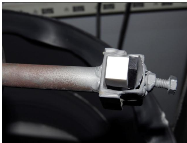
Slika 3.12 Uzorak u držaču uređaja za ispitivanje otpornosti na erozijsko trošenje
