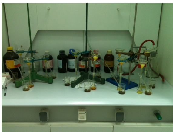
Slika 22. Filtriranje ohlađenih uzoraka tla u digestoru
