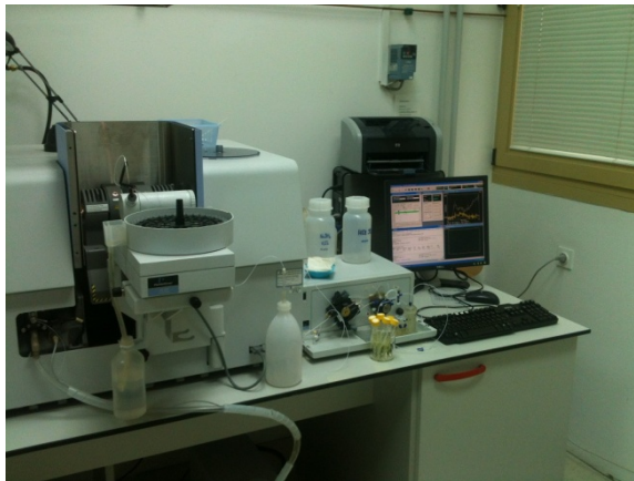
Slika 23. Atomski apsorpcijski spektrometar: PerkinElmer Analyst 800
