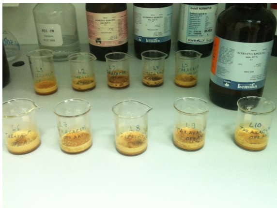
Slika 24. Postupak pripreme uzoraka biljnog materijala za određivanje teških metala: uzorci biljnog materijala nakon vaganja (1g) u staklenim čašama od 50 ml u koje je dodano 10 ml nitratne kiseline i 3 ml perklorne kiseline
