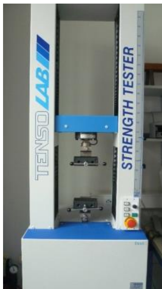
Slika 18. Kidalica Tensolab 3000, tt. Mesdan S.p.A., Italija
