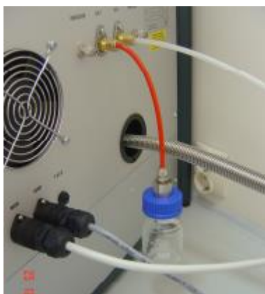
Slika 16. Monomer boca u sustavu za PE-CVD postupak
