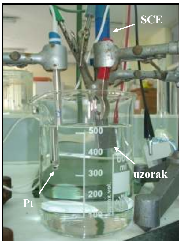
Slika 1. Troelektrodna staklena ćelija za elektrokemijska mjerenja
