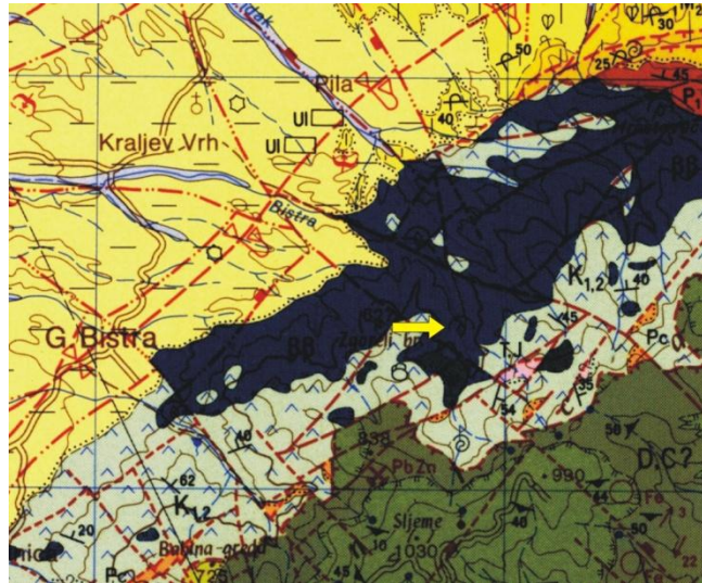
Slika 1.4. Dio karte preuzet sa Osnovne geološke karte, list Zagreb (Šikić et al., 1977), izvorno mjerilo je 1:100 000, a razmak između linija je 5 km. Žutom strelicom označen je točan položaj kamenoloma unutar tamnoplavog područja koje označava kredne efuzije, koji se na terenu vide kao spiliti i dijabazi. Okolno svjetloplavo područje su kredni sedimenti i sedimentne stijene.
