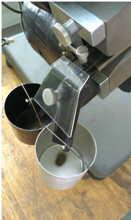
Slika 4–8 Frantzov izodinamski magnetski separator; u svijetliju posudicu izlaze magnetični minerali, a u tamniju ne magnetični minerali na određenoj jakosti struje
