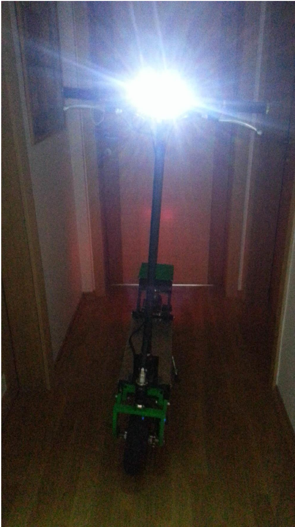
Slika 42. Prednje LED svjetlo ukupne snage 12W
