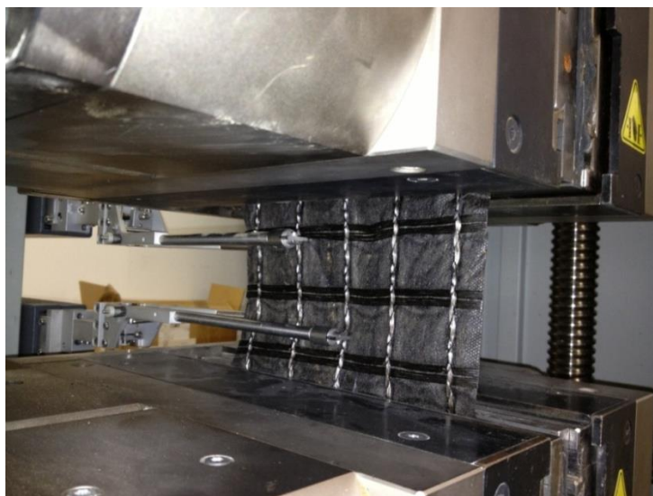
Slika 24. Uzorak geomreže pravilno postavljen u ekstenziometar
