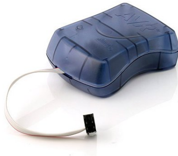
Slika 5.13: ATMEL AVR MKII programator [11]
