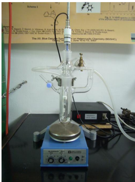
Slika 1. Aparatura za fotokatalitičku oksigenaciju
