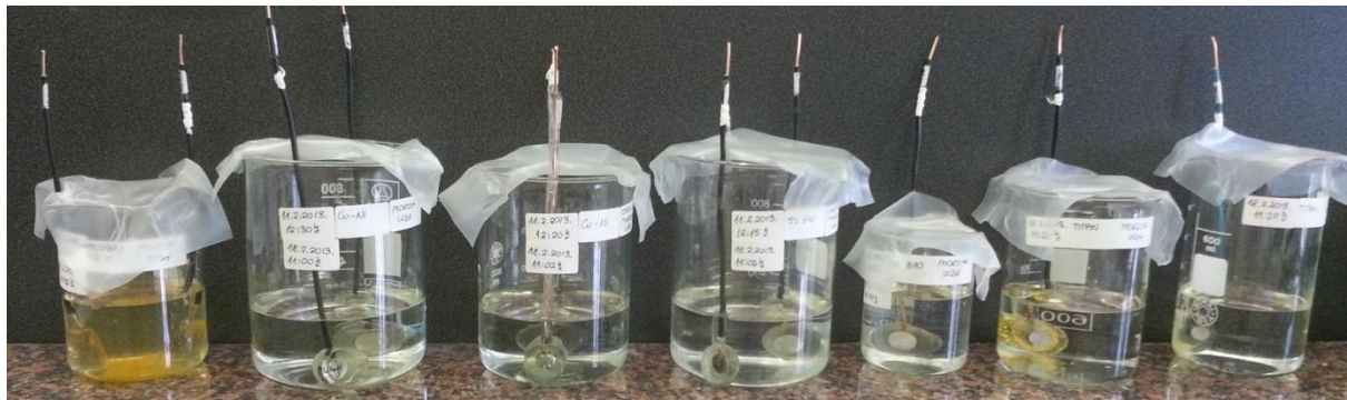
Slika 7. Uzorci metala uronjeni u prirodnu morsku i steriliziranu morsku vodu
