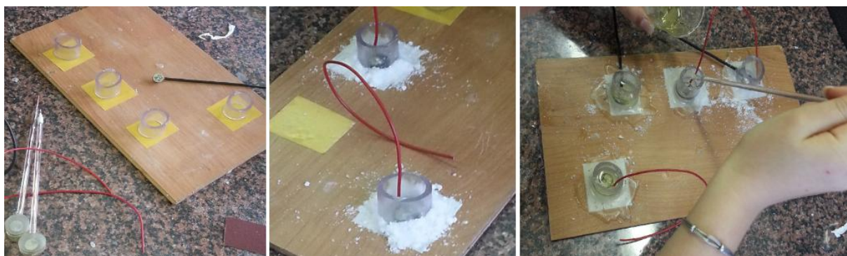
Slika 4. Postupak pripreme radnih elektroda, postavljanje kalupa i izolacija dvokomponentnom epoksidnom smolom
