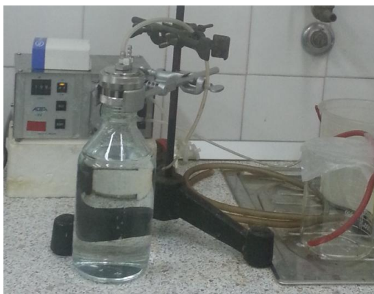
Slika 6. Aparatura korištena pri sterilizaciji morske vode metodom membranske filtracije
