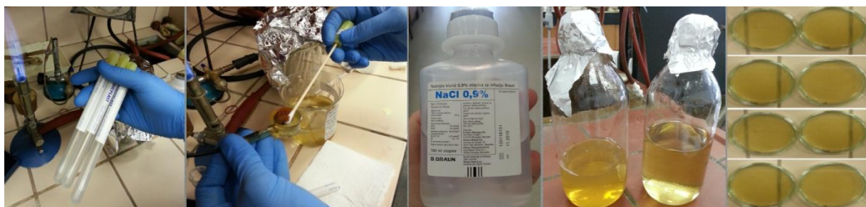
Slika 14. Postupak izolacije aerobnih bakterija iz porodice Pseudomonadaceae s površine metala
