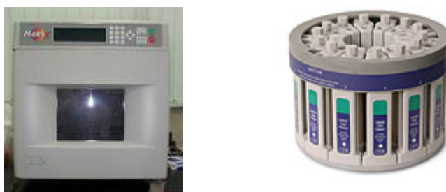
Slika 5. Uređaj za mikrovalnu ekstrakciju s teflonskim posudama za uzorke
