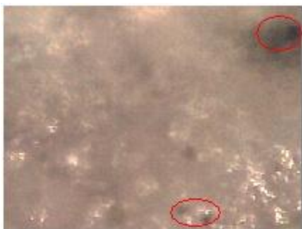
Slika 37: Tragovi ugljena na alatki 3, uvećanje 100x.
