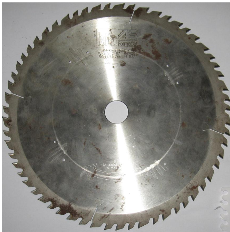
Slika 5.4. Pila 2 proizvođača Leitz s 60 zubi WZ oblika i promjera 300mm
