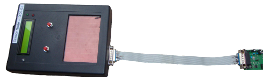
Slika 2.48. Način povezivanja senzorske stanice i senzorske sonde
