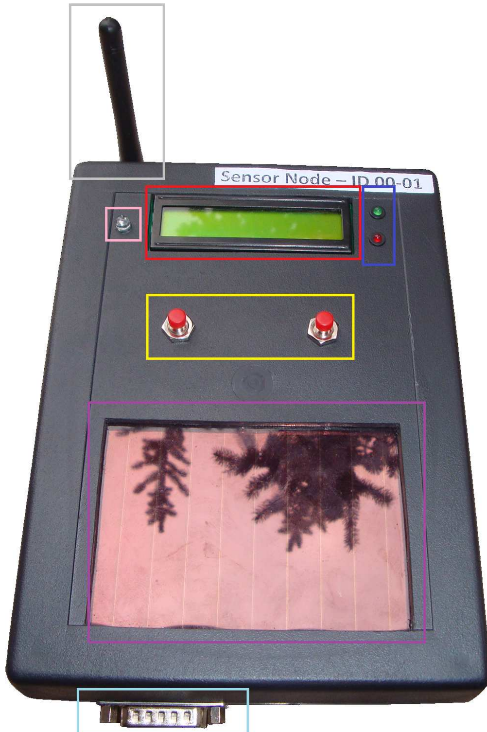
Slika 2.38. Izrađena senzorska stanica sa označenim dijelovima
