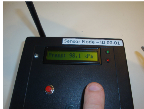
Slika 2.42. Čitanje zadnje vrijednosti tlaka zraka
