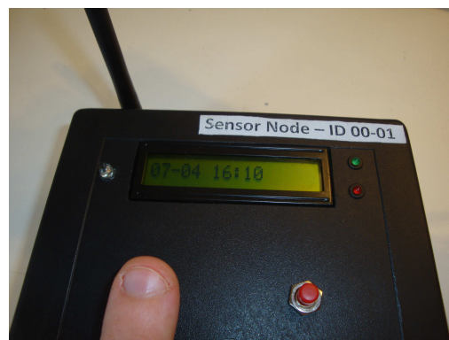
Slika 2.44. Prikaz vremena paljenja stanice
