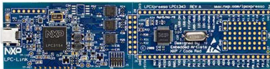
Slika 3.1. Razvojna pločica LPCXpresso sa JTAG debuggerom i mikrokontrolerom LPC1343
