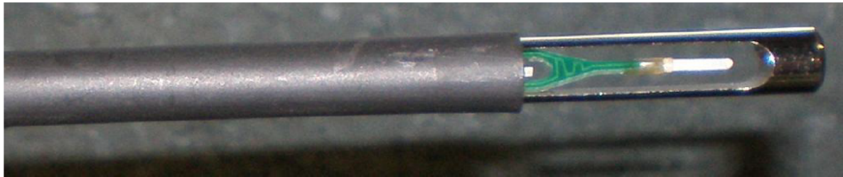
Slika 16. Anemometar sa žarnom niti korišten u radu.
