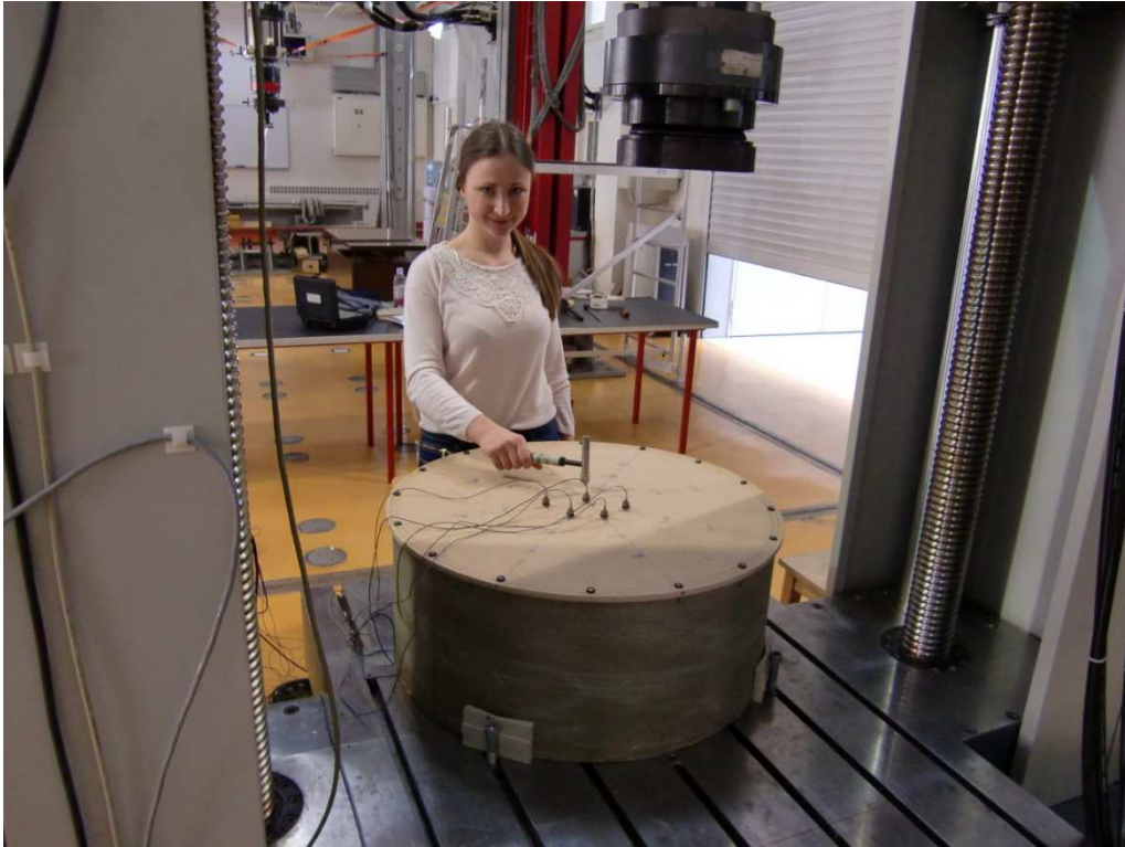
Slika 11. Pobuđivanje konstrukcije kod OMA – e
