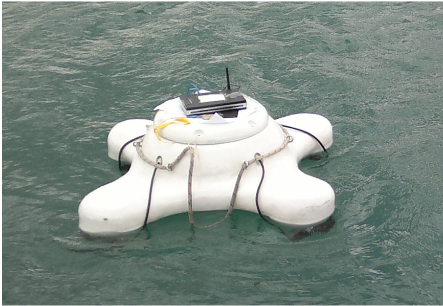
Slika 3.1: PlayDyPos autonomna platforma na jezeru Jarun u Zagrebu
