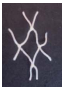
Slika 23. Prikaz pripremljenog uzorka za ispitivanje čvrstoće oka ribarske mreže
