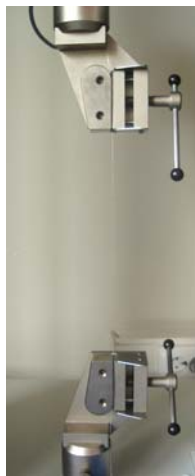
Slika 19. Prikaz multifilamentne pređe između stezaljki dinamometra udaljenih 250 mm
