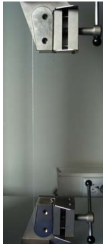
Slika 20. Prikaz končane pređe između stezaljki dinamometra udaljenih 250 mm
