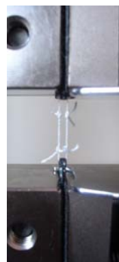
Slika 24. Prikaz načina postavljanja uzorka između stezaljki dinamometra prilikom ispitivanja čvrstoće oka ribarske mreže
