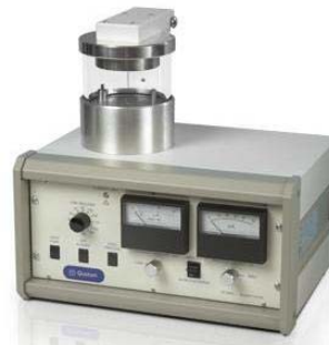
Slika 15. Instrument za neparivanje uzoraka SC7620 Mini Sputter coater
