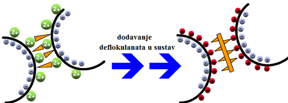
Slika 1.6. Utjecaj izmjene kationa na električni dvosloj u svrhu povećanja njegove debljine [15].
