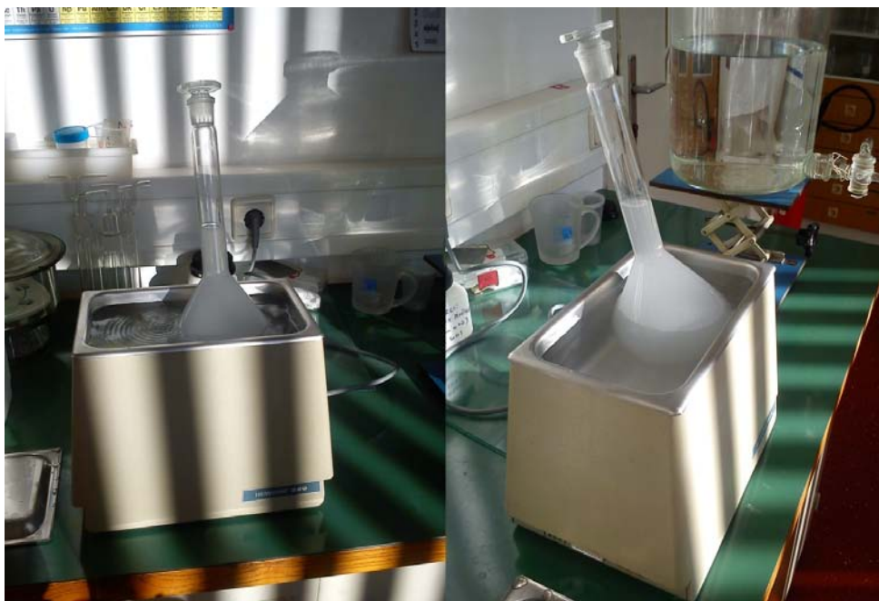
Slika 3.2. Homogenizacija 0,01 %-tnih \text{Al}_2\text{O}_3 -t- \text{ZrO}_2 suspenzija za mjerenje zeta potencijala u ultrazvučnoj kupelji.
