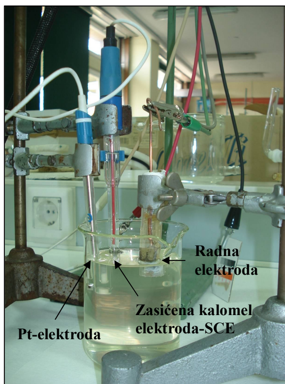
Slika 1. Aparatura za provođenje elektrokemijskih mjerenja
