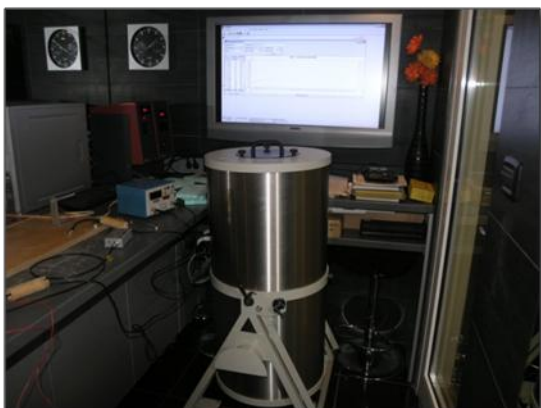
Slika 8.4.: Spravljanje i ugradnja betonskih mješavina (a), postavljanje svježeg uzorka betona sa sondom u kalorimetar (b), podešavanje mjernih uređaja kalorimetra (c) i mjerenje topline hidratacije (d)
