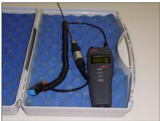
Slika 8.3.: Laboratorijsko mjerenje temperature (a) na uzorcima svježeg betona i određivanje tlačne čvrstoće uzoraka (b)
