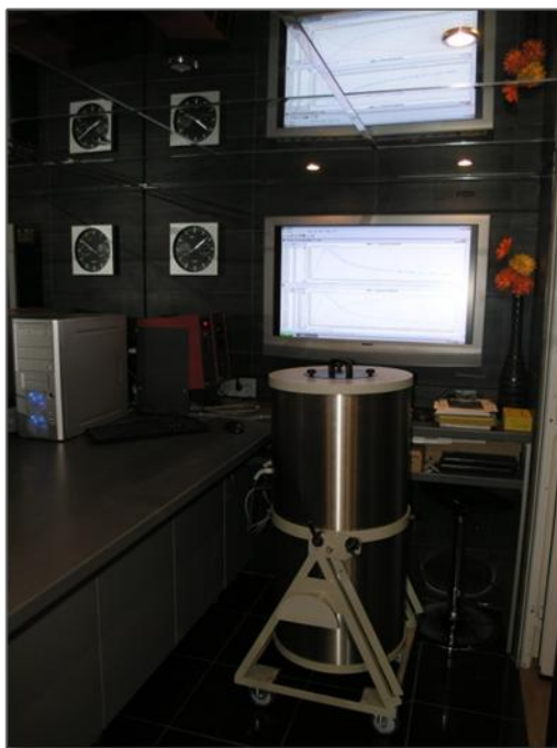
Slika 5.4.: Diferencijalni kalorimetar ToniCAL, model 7336
