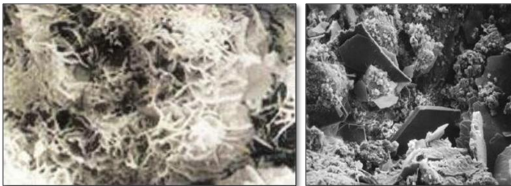
Slika 4.10.: Mikroskopski prikaz produkta nastalih hidratacijom C_4AF [5]
