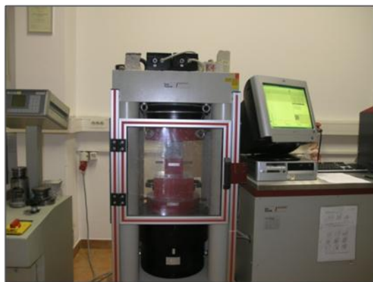
Slika 8.3.: Laboratorijsko mjerenje temperature (a) na uzorcima svježeg betona i određivanje tlačne čvrstoće uzoraka (b)
