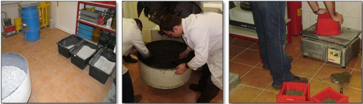
Slika 8.1.: Spravljanje i ugradnja betonskih mješavina u laboratoriju
