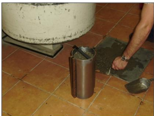
Slika 8.3.: Laboratorijsko mjerenje temperature (a) na uzorcima svježeg betona i određivanje tlačne čvrstoće uzoraka (b)
