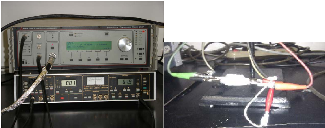
Slika 3.2 - Shematski prikaz i izgled aparature za impedancijska mjerenja
