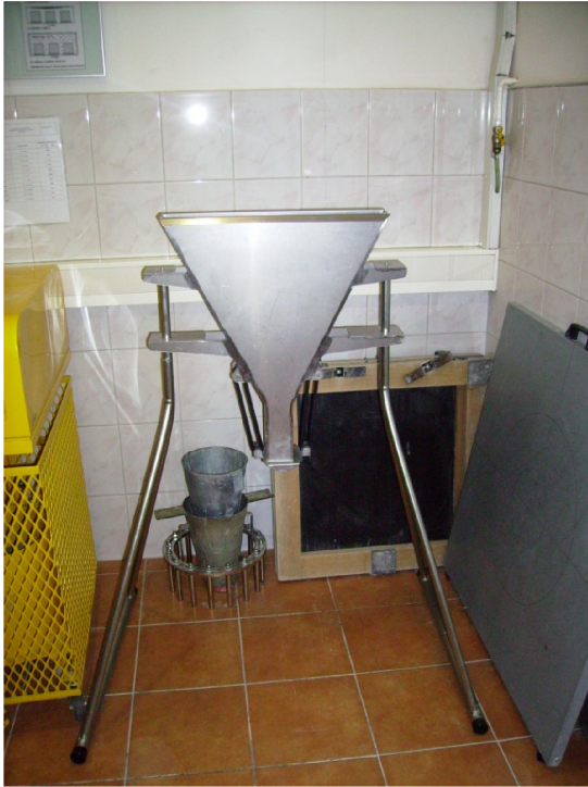
Slika 28. Izgled i unutarnje dimenzije V-lijevka
