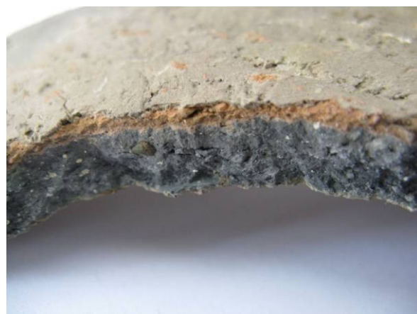
Slika 2-4. A – ulomak keramike N-57; B – presjek okomit na stijenku ulomka keramike N-57.
