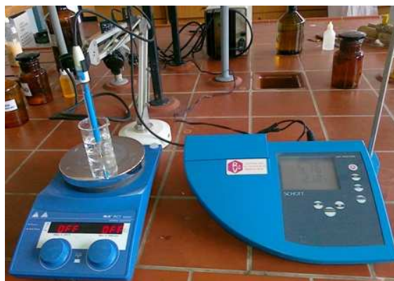
Slika 9. pH metar CG 842, Scott, CG 842 sa elektrodom BlueLine 14 pH, Geräte GmbH, Njemačka,
