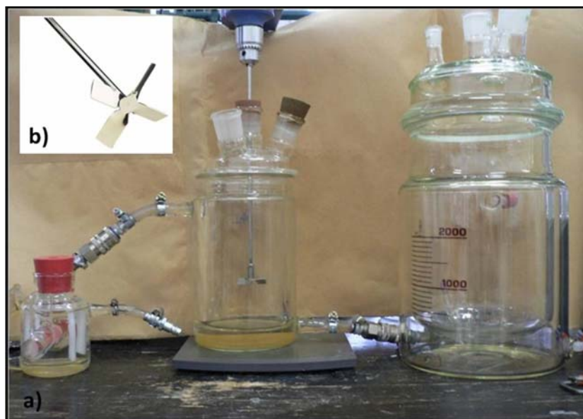
Slika 10. Miješalice korištene za miješanje sustava čvrsto-kapljevito i kapljevina-kapljevina
