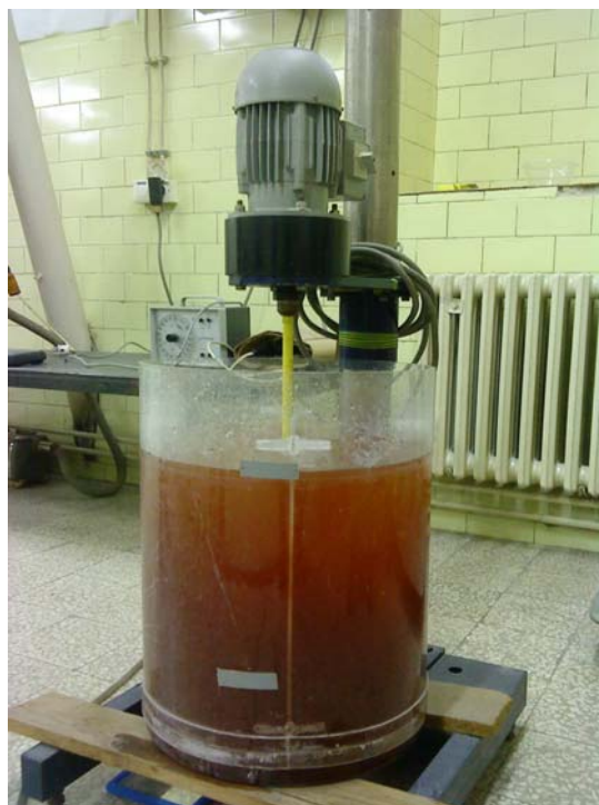
Slika 22. Poluindustrijska miješalica pri brzini vrtnje miješala, n = 180 \text{ min}^{-1} , koncentracije suspenzije amberlita (uzorak 1) od 1 vol%
