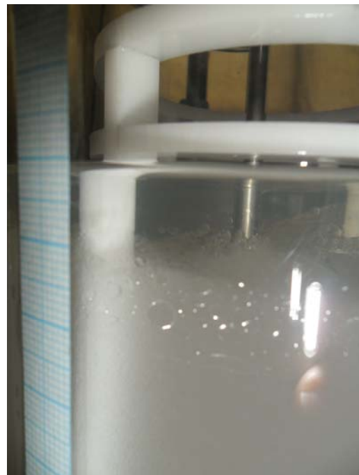
Slika 23. Utjecaj razbijala na postizanje stanja potpune disperzije ( n=600 \text{ min}^{-1} )
