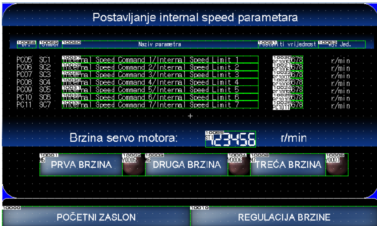
Slika 30. Zaslom za regulaciju brzine servo motora prethodno postavljenim parametrima
