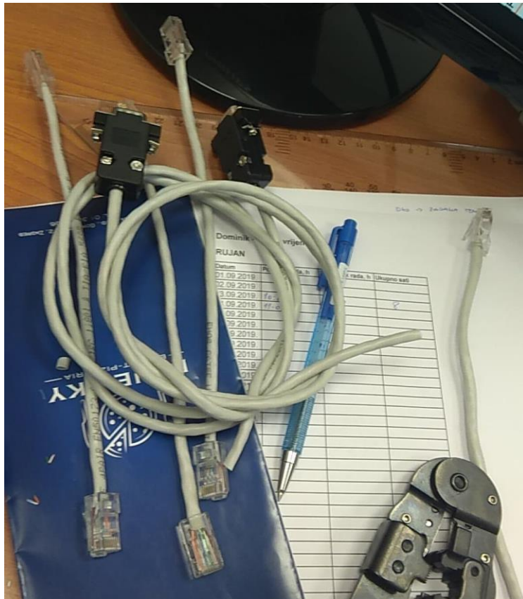
Slika 6. Komunikacijski kabeli RS422 i Ethernet
