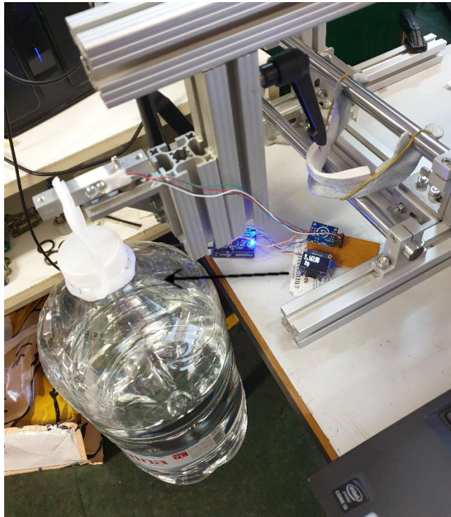
Slika 9. Vaga umjerena predmetom poznate mase (strelica)
